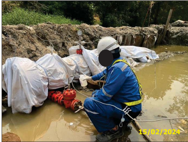
การเก็บตัวอย่างน้ำทิ้งจากการทดสอบท่อฯ ด้วยวิธีทางชลสถิต (Hydrostatic Test) ครั้งที่ 1 เมื่อวันที่ 15 กุมภาพันธ์ พ.ศ. 2567
